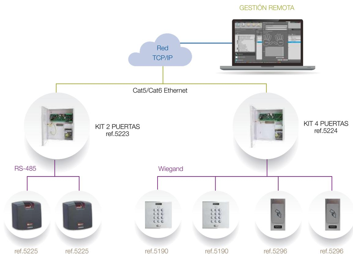
Sistema basado en controladores IP, que se pueden instalar utilizando varios puntos de red en la misma instalación, con 1 controlador por cada 2 o 4 puertas.
